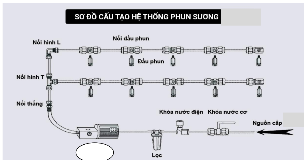
Hình 4.7: Sơ đồ cấu tạo hệ thống phun sương
