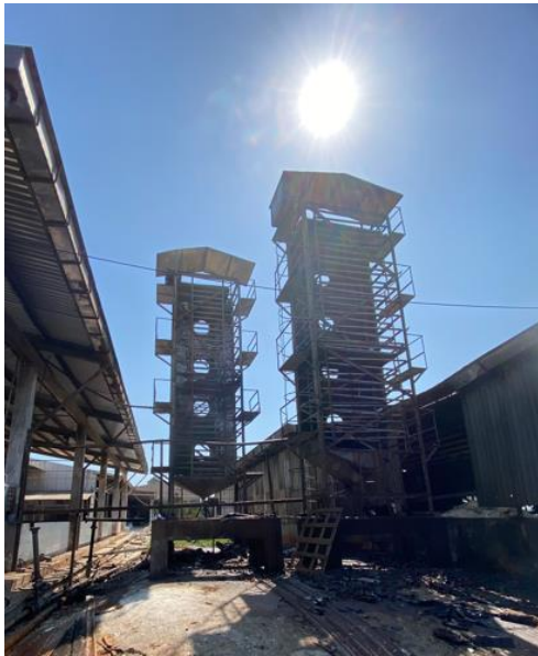
Hình 3. 15: Tháp khử \text{NH}_3 (hình trái) và hệ thống mương spillway (hình phải)
