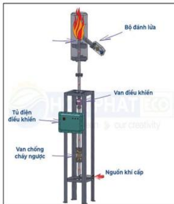
Hình 3.7. Sơ đồ mô tả thiết bị đốt khí tự động, công suất 20 m 3 /h
