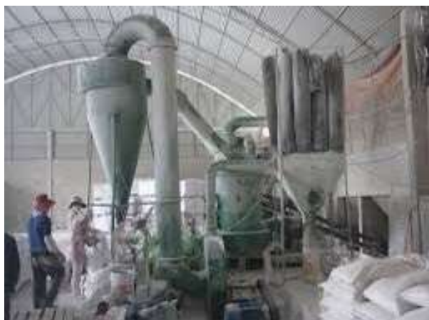
Hình 8. Công nghệ sản xuất nghiền cao lanh tại nhà máy
