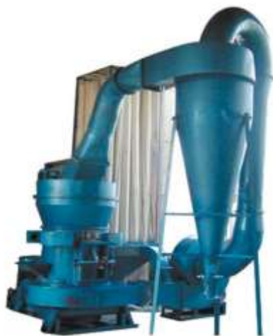
Hình 5. Hệ thống máy nghiền bột cao lanh tại nhà máy
